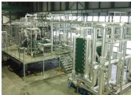
二段ランキンサイクルシステム 【高性能システム開発】
