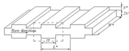
$$L=1295\text{mm} \quad h^*=2.5\text{mm} \quad L^*=20\text{mm} \quad W^*=200\text{mm}$$
