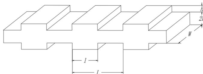
$L=20\text{mm}$ ,  $W=200\text{mm}$ ,  $h=2.5\text{mm}$ ,  $l=4, 6, 8, 10, 12\text{mm}$
