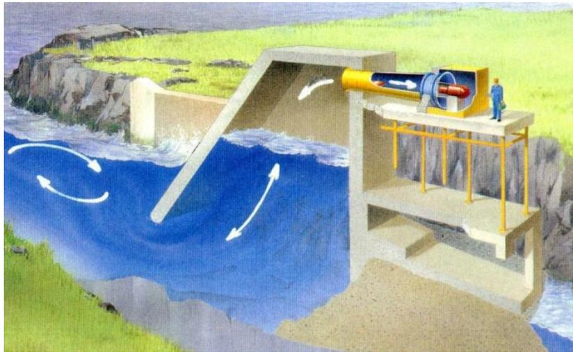
図 1 OWC 波力発電装置
